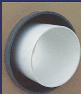
1. Centrez le tuyau, le câble ou le conduit dans le manchon mural, le fourreau ou le trou percé. Assurez-vous que le tuyau est correctement soutenu aux deux extrémités. Les Innerlynx® ne sont pas conçus pour supporter le poids du tuyau.
